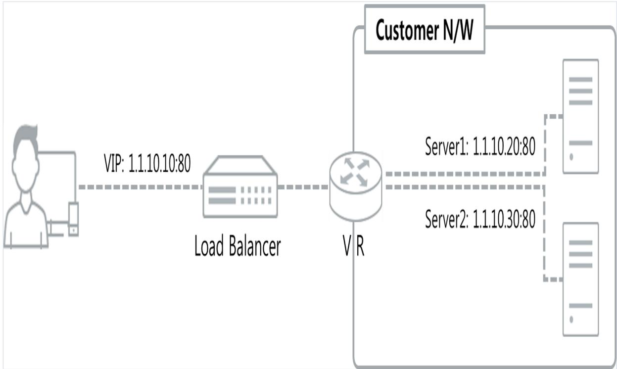
위 그림에서와 같이 클라이언트는 실제 back-end에 위치한 서버의 주소가 아닌, 가상 IP주소(Virtual IP;VIP)로 접근합니다. VIP로 들어온 클라이언트 요청은 로드밸런서에 설정한 로드밸런서 옵션에 따라 back-end 서버들 중 적합한 대상 IP/Port를 설정합니다. 설정 된 대상 IP/Port 주소를 기반으로 클라이언트 요청은 포트포워딩 NAT기능을 하는 가상 라우터(Virtual Router; VR)를 통해 각 서비스에 도달하게 됩니다. KT ucloud biz에서 로드밸런싱 서비스를 사용하는 절차는 다음과 같습니다.
