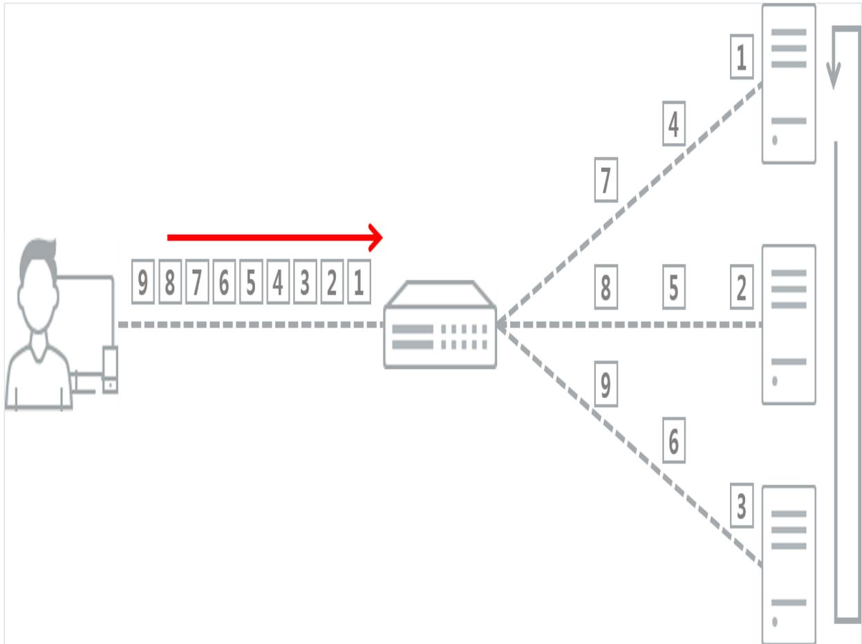
위 그림과 같이 back-end에 4개의 서버가 존재하는 경우 '서버 1' 부터 '서버 3' 까지 새로운 연결이 생길 때 마다, 1-2-3-1-2...과 같이 순환을 하는 방식입니다. 응답 시간이 빠르고 구성이 단순하다는 점이 장점입니다. 단, back-end 서버에 균등한 부하 분산이 이루어지지 않으며 무조건 순차적으로 포워딩 하므로 결제 시스템과 같이 연결 유지에 높은 신뢰가 요구되는 서비스인 경우 추천하지 않습니다.
